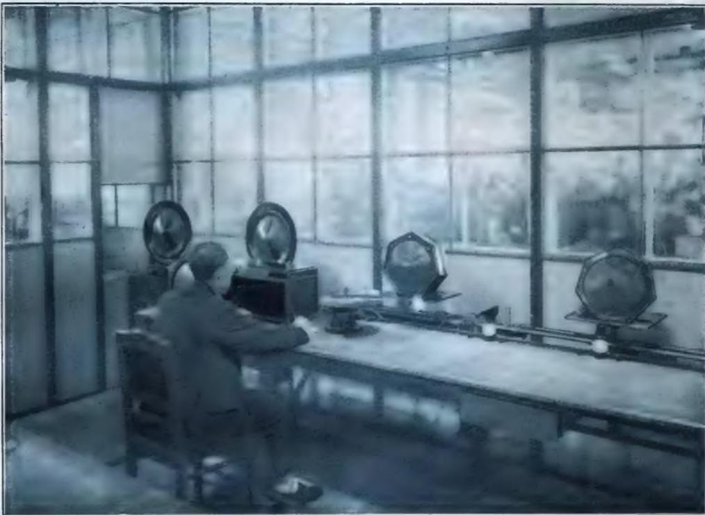
Jeder Lautsprecher durchwandert auf dem laufenden Band einen Kontrollraum, wobei er sich automatisch an einen Empfänger schaltet. Gleichzeitig findet ein Vergleich mit einem Normallautsprecher statt.
